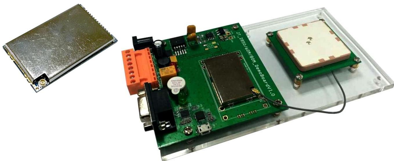
JT-2850 是一款体积小、超低功耗、读写模块，支持 EPC C1 G2 /ISO 18000-6C 协议，配合 45x45mm 的陶瓷天线，读取普通白卡，实测可达到：60~80cm。
